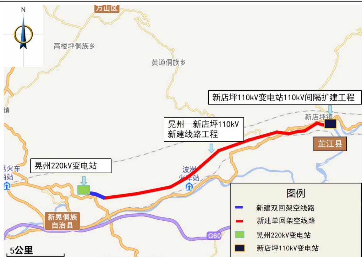
图 3 晃州~新店 110kV 新建线路路径示意图
